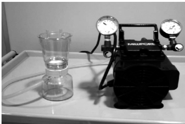
Imagen 1. Set de filtración y bomba de vacío utilizadas para control microbiológico de nutrición parental utilizado en método de filtración (adaptado Montejó y cols.)
